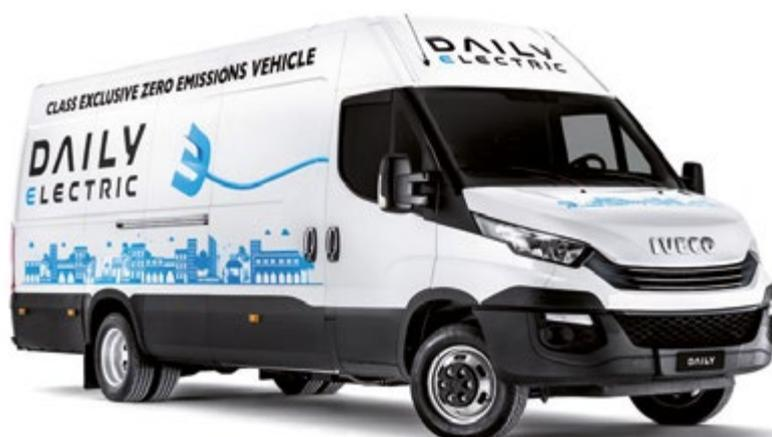
Viel Platz bietet beispielsweise der Iveco Daily Electric. Stauvolumen (Kastenwagen): bis zu 15 600 l. Reichweite: bis zu 280 km. Drei Batteriemodule, Schnellladung in zwei Stunden. Es gibt ihn in fünf Längen und drei Höhen, in den Gewichtsklassen 3,5 bzw. 4,4 und 5,2 Tonnen Gesamtgewicht sowie als Fahrgestell mit Normkabine.
