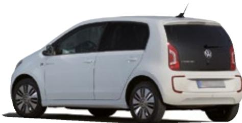
*VW E-Load UP, als reine Transporter-version ohne Rückbank, mit ebenem Laderaumboden, dunklen Scheiben hinten. Lithium-Ionen-Akku-Paket, Reichweite: 160 km.*
