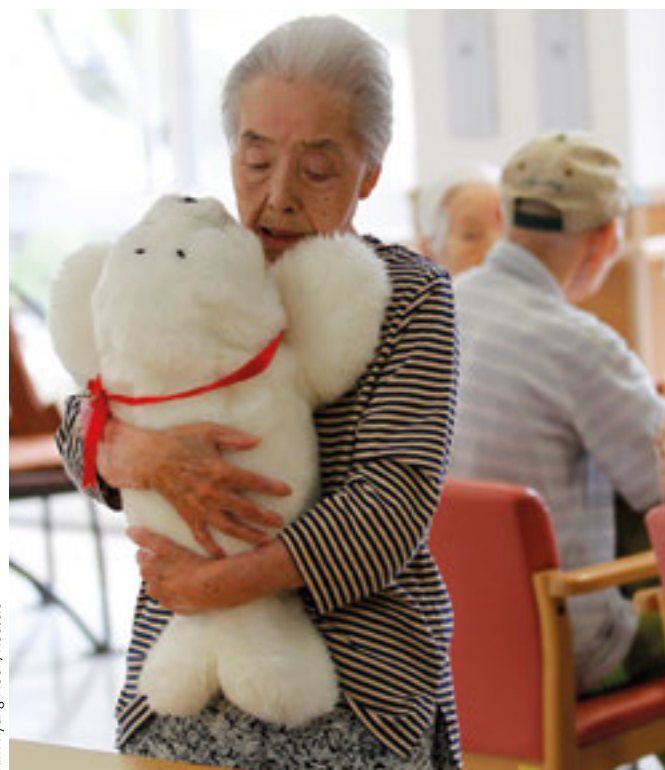
Mit Kuschelfaktor: Bei der japanischen Therapierobbe „Paro“ sorgen elektronische Sensoren dafür, dass sie den Kopf bewegen und auf Streicheln mit wohligen Lauten reagieren kann. Japan gilt als Vorreiter in der Entwicklung von Robotern für die Pflege.
