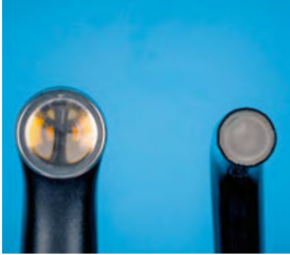
Abb. 3 Beispiele unterschiedlicher Durchmesser von Lichtaustrittsfenstern
