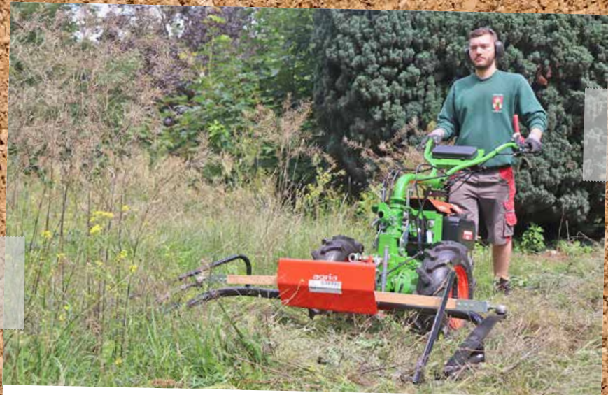
Einen Balkenmäher hat das Umweltamt Mitte angeschafft. Mit der Maschine sollen ausgewählte Grünflächen umweltschonender gemäht werden. Auf den beiden Pilotflächen am Plötzensee und am Möwensee werden Gräser und Wildstauden damit nicht mehr in so niedriger Höhe abgeschnitten.
