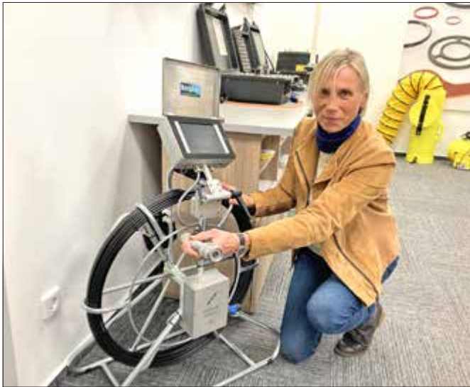
Dagmar Rauchfuss mit Kameraapparat zur Kanalüberprüfung Foto: bs
