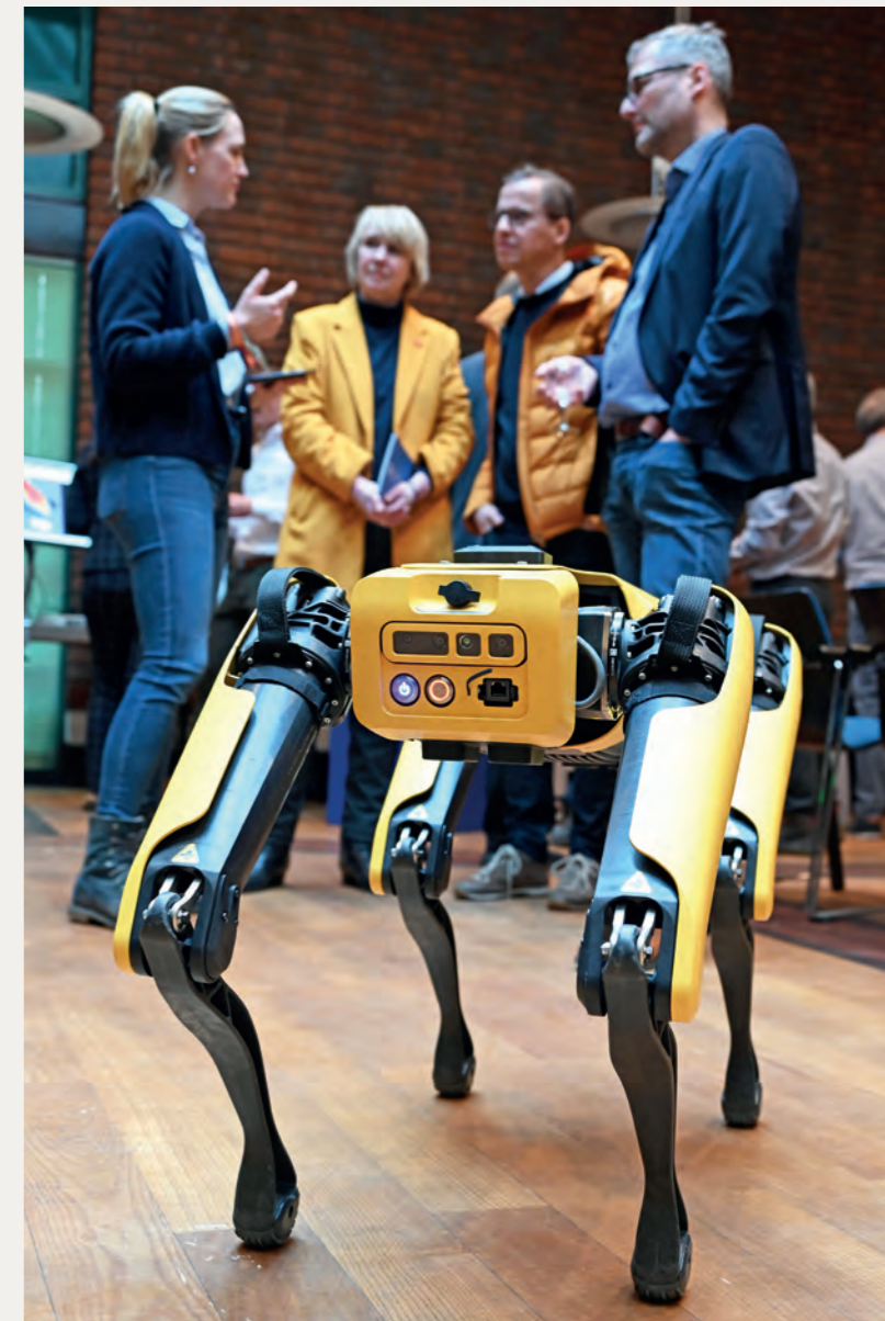
Roboterhund Spot identifiziert ganz autonom beispielsweise beschädigte Leitungen.
