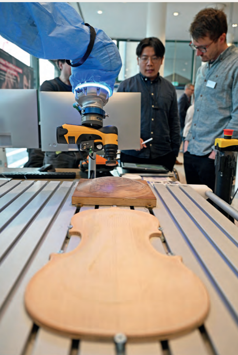
Der Roboter des Projekts Lerosh schleift Holz eigenständig glatt.
