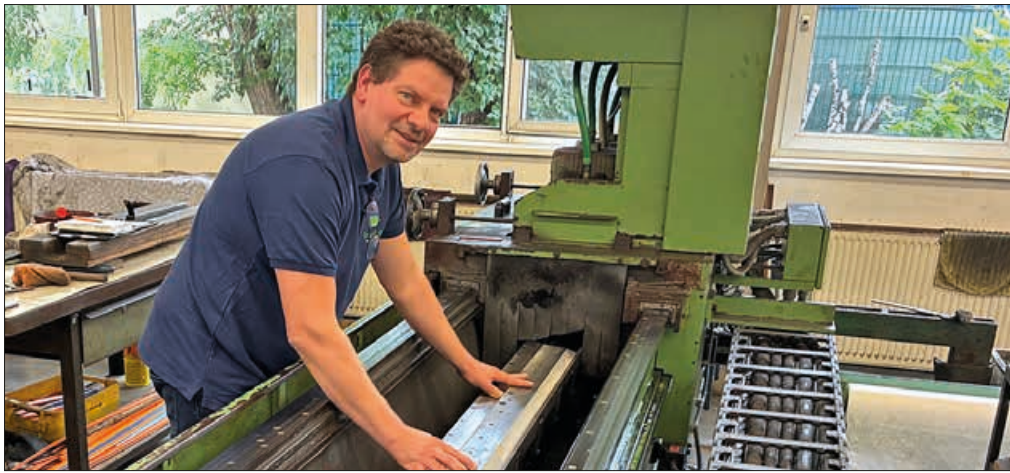
Ulrich Brucklacher an einer „Langmesserschleifmaschine“. Die Langmesser schneiden Papier. Kunden sind Druckereien und Buchbinder. Foto: bs
